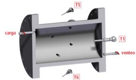
Fig. 3 - Disposición de las termorresistencias
