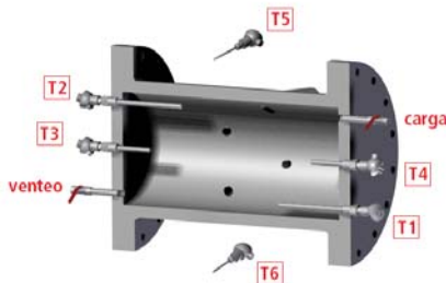
Fig. 2 – Disposición de las termorresistencias
