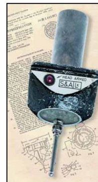
Fig. 1. Primeiro apalpador 3D patentado por McMurty [3]
