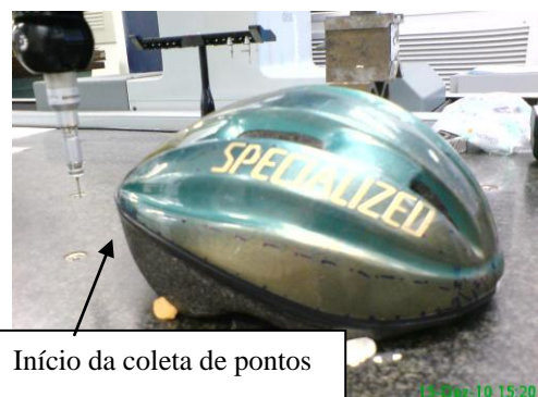
Figura 7. Região contendo os pontos a ser coletados pela Máquina de Medição por Coordenadas
