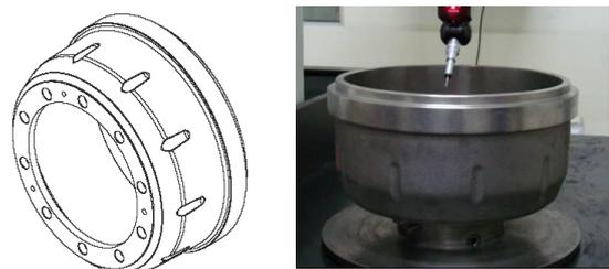
**Figura 3 – Desenho 3D da peça (a) e montagem da peça na MMC (b)**
