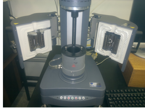
Figura 2: reômetro utilizado para medição de viscosidade dinâmica.
