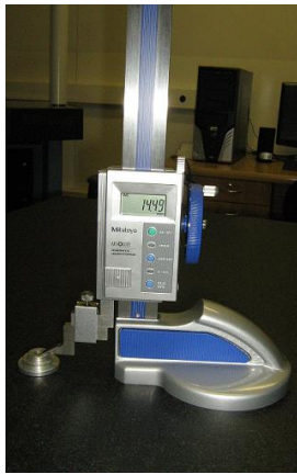
Fig. 1. Medição da altura com traçador de altura
