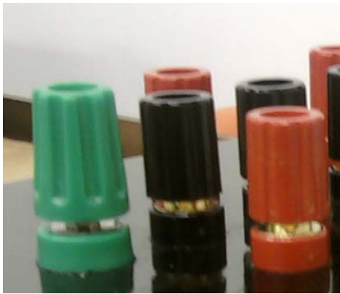
Fig. 5 – Detalhe dos terminais de conexão do transfer
