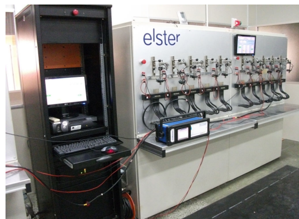
Figura 1. Padrão de calibração e banca de ensaio de exatidão
