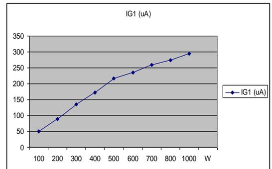
Figure 7: Corrente de gate de  $M_0$  em função de W
