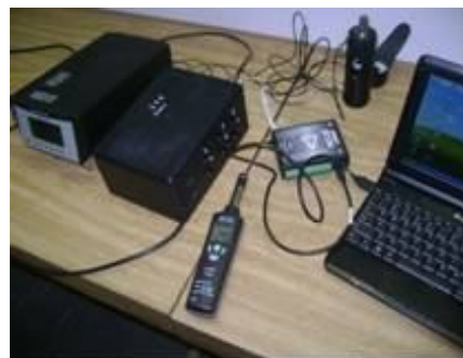
Figura 3 - Sistema 2 (Acelerômetro piezoelétrico (B&K), condicionador desenvolvido e conversor A/D DT-9812).
