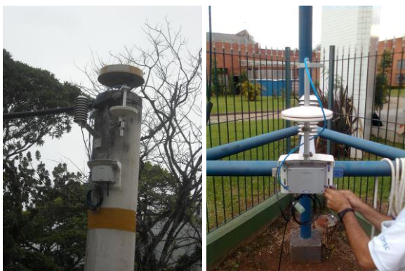
Fig. 1. Estação de monitoramento ( GPS e PTU ) de Ubatuba-SP e PTU303 com "static pressure head", Vaisala (Fotos: CPTEC/Sapucci e LIM/Paulo Arlino)
