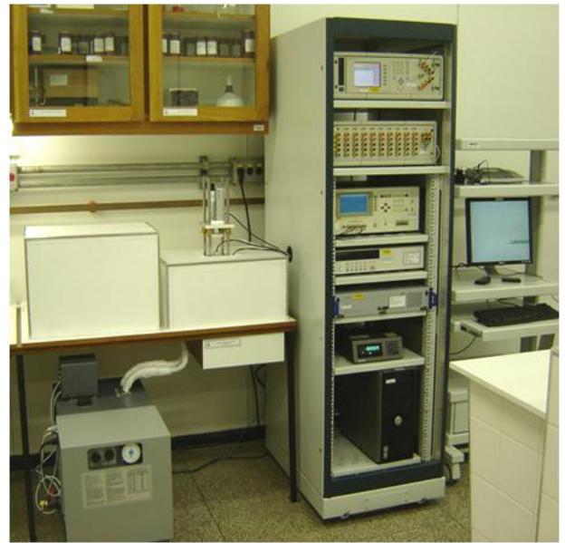
Figura 2. Sistema primário de medição de condutividade eletrolítica do Inmetro.
