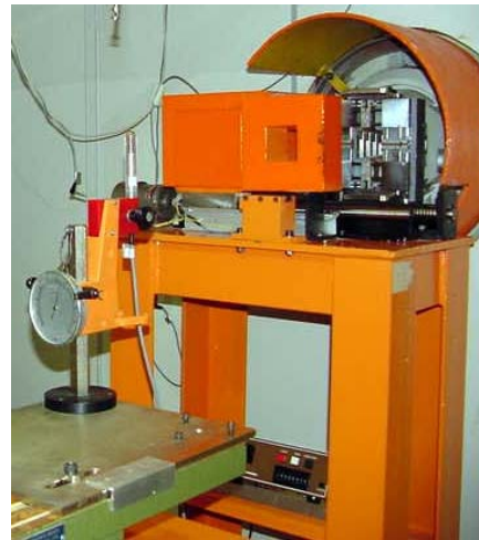
FIG 2-Posicionamento da câmara em frete ao 60 Co para medida do kerma no Ar.
