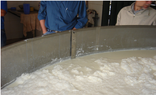
Fig. 3 – Tanque com escala para medição do nível do leite Fonte: Pesquisa de campo do GT SML
