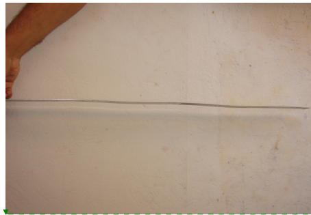
Fig. 5 – Escala deformada Fonte: Pesquisa de campo do GT SML
