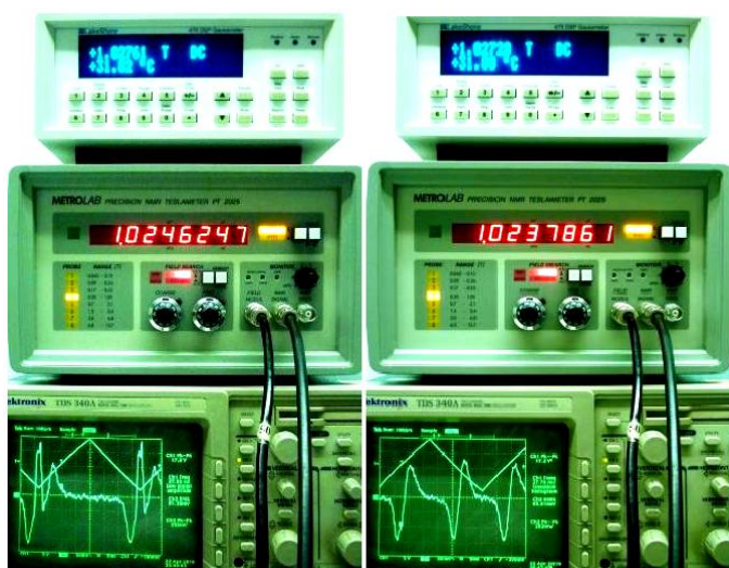
Fig. 8. À direita, sintonia correta ( B \sim 1 T): picos de absorção equidistantes. À esquerda, sintonia diferente da frequência de Larmor: picos agrupados. No topo, o gaussímetro Hall que controla o campo. No meio, o teslameter RMN comercial, que executa a medição.
