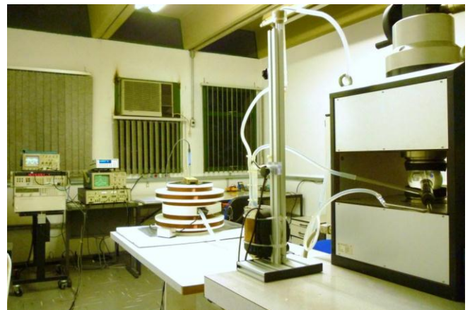
Fig. 7. Arranjo experimental do magnetômetro RMN de fluxo contínuo montado no IPT. Em primeiro plano, o eletroímã usado como polarizador e o sistema de bombeamento de água. No segundo plano, a bobina onde o campo é medido, e ao fundo, a instrumentação de medição e controle.
