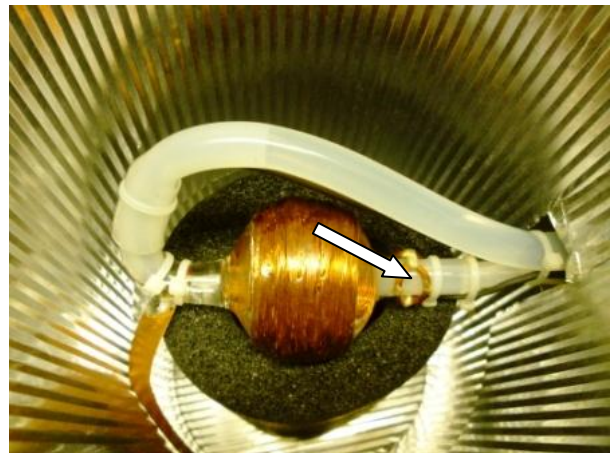
Fig. 6. Transdutor de RMN posicionado no interior da bobina de precisão. A bobina maior, ao centro, é o pick-up do sinal de precessão. A pequena bobina, à direita, envolvendo o duto de entrada, é responsável pela excitação. O retorno do fluxo de água é feito pelo tubo superior.
