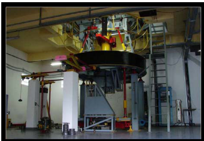
Fig. 1a. A balança externa do túnel de vento TA2 do Instituto de Aeronáutica e Espaço (IAE).
