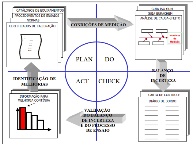
Figura 9. Ciclo PDCA e ferramentas da qualidade no gerenciamento da incerteza de medição nos ensaios de combustíveis [22]
