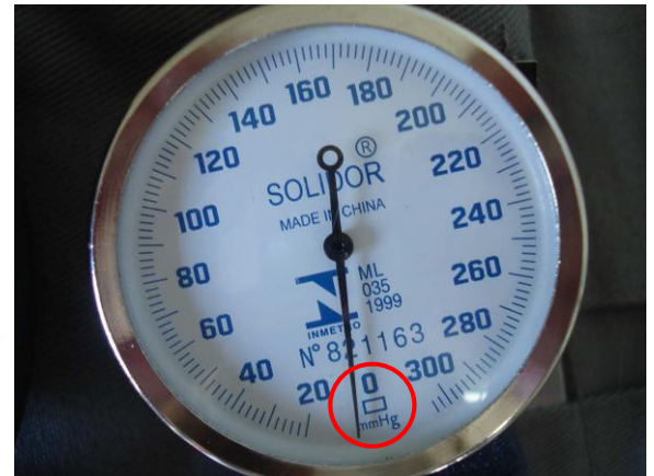
Fig.3. Indicação inadequada de “zero”.
