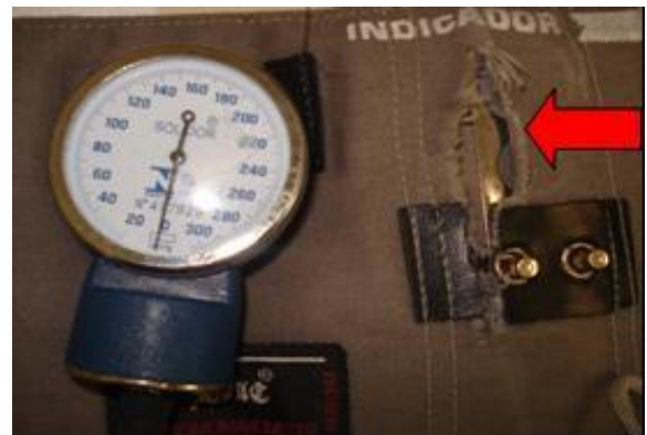
Fig. 4. Braçadeira em mau estado.
