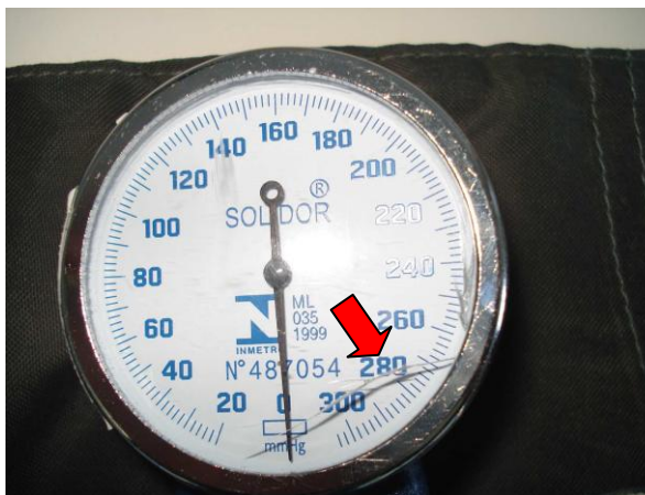
Fig. 7. Instrumento apresentado rachadura.
